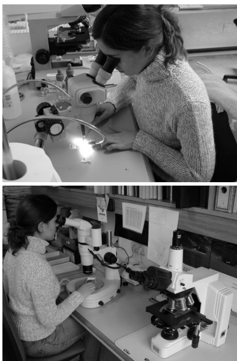
Figura 11.- Equipos ópticos empleados en el estudio de Myxomycetes. Lupas binoculares o estereomicroscopios dotados de luz fría y microscopio óptico.
